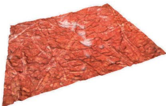
Abb. 7: Ursachenforschung von mangelhaftem Druckbild mit dem „Speckle Effekt“. Der Anwender misst direkt im optischen Farbbild seiner Papieroberfläche. Anhand der Echtfarbandarstellung sind die blanken Stellen im Papier mühelos und präzise zu lokalisieren und zu messen
