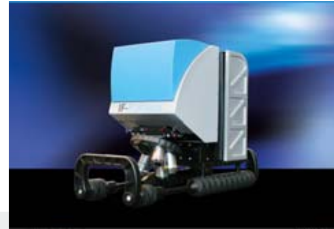
Der IF-Portable von Alicona ist ein mobiles optisches Messsystem zur fertigungsintegrierten Qualitätssicherung. Das Gerät ist sowohl für die Messung von gekrümmten und als auch für ebene, glatte Oberflächen geeignet.
