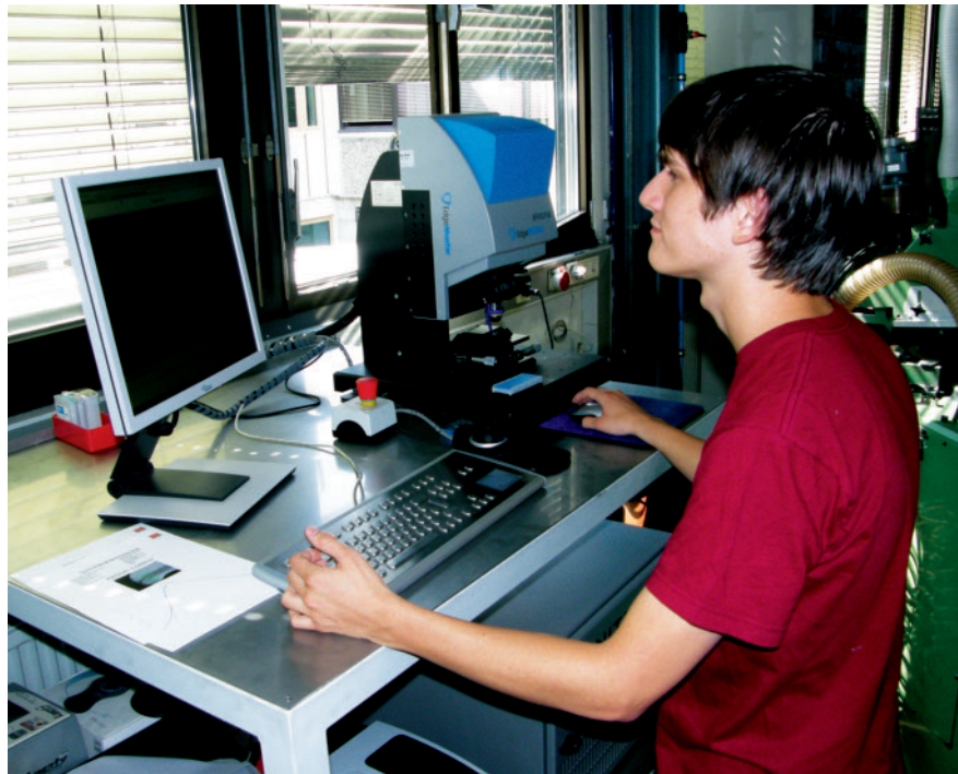
Bild 3. Der »EdgeMaster« ist direkt neben der fertigenden Verrundungsmaschine platziert. Die automatisierten Messungen sorgen für eine hohe Bedienerunabhängigkeit
