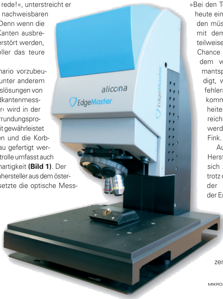
Bild 1. Optische Schneidkantenmessung: Das 3D-Messsystem von Alicona misst Schlüsselparameter wie Radien und Winkel in höchster vertikaler und lateraler Auflösung. Die große Scanhöhe des Systems schafft weitere Freiheitsgrade
