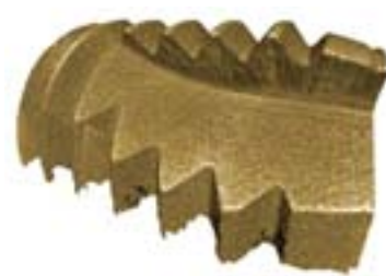
Das optische 3D-Oberflächenmessgerät Infinite Focus (links) wird zur Qualitätssicherung von Zahnimplantaten und künstlichen Gelenken eingesetzt. Oben: Das 3D-Oberflächenmodell eines Zahnimplantats
