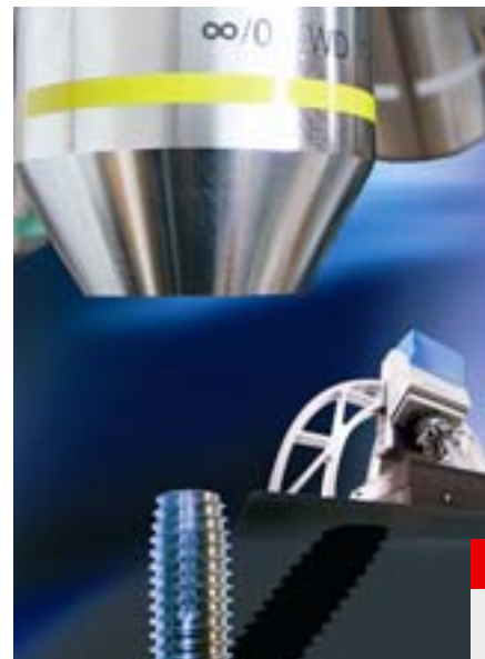
Das optische 3D-Oberflächenmessgerät Infinite Focus (links) wird zur Qualitätssicherung von Zahnimplantaten und künstlichen Gelenken eingesetzt. Oben: Das 3D-Oberflächenmodell eines Zahnimplantats
